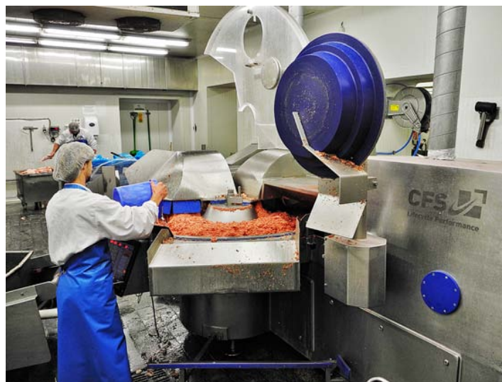
Obr. č. 2: Jednou z klíčových fází výroby fermentovaných salámů je příprava díla. Ve firmě Pejskar k tomu slouží nový „dvouhlavý“ kutr s objemem mísy 500l.
